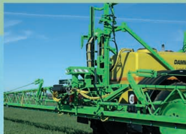
Ovjes armature. Mjerilo za najveću stabilnost i najoptimalniji položaj armature. To je preduvjet za optimalnu aplikaciju.
