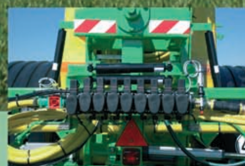
Visoko vrijedna električna instalacija za upravljanje sekcijama armature
