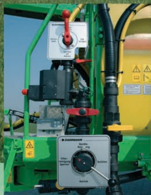
Jednostavno posluživanje pomoću centralnog ventila u usisnom i tlačnom dijelu
