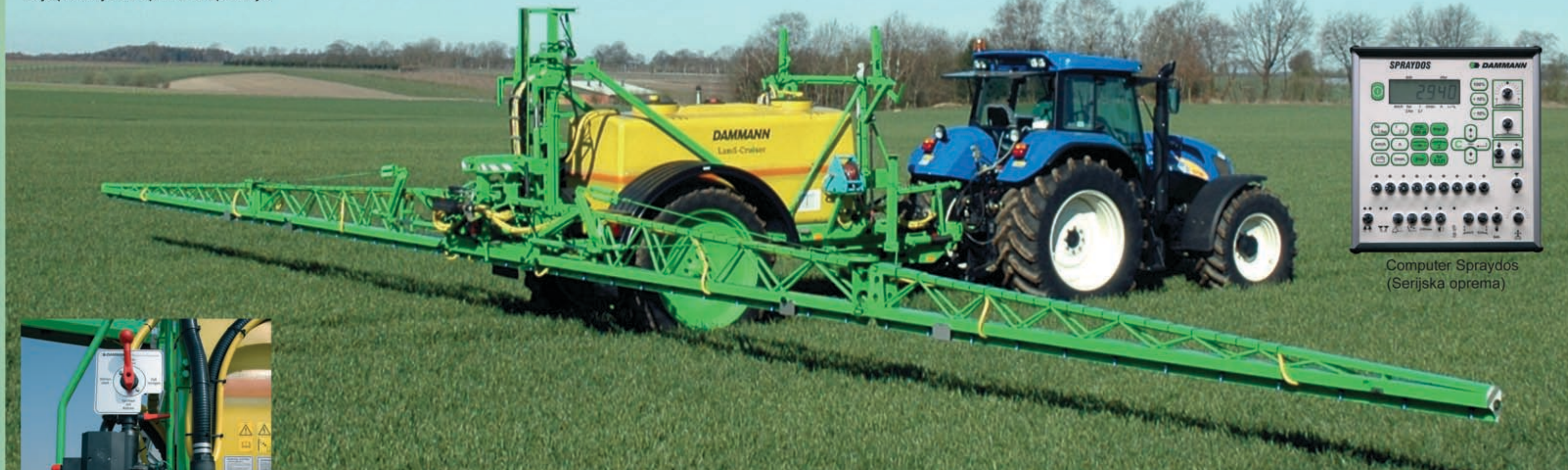
Ovjes armature. Mjerilo za najveću stabilnost i najoptimalniji položaj armature. To je preduvjet za optimalnu aplikaciju.
