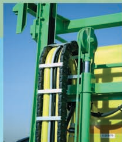
Centralna vodilica za crijeva pomoću lanca - vodilice
