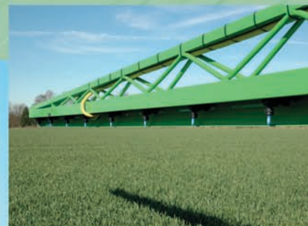
Armatura stabilne izvedbe sa zaštićenim dizama, hidraulično sklapanje
